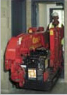
Der UNIC A295CRE ist der erste Miniraupenkran auf dem Europäischen Markt, der mit einer Tragkraft von ca. 3 t noch schmal genug ist (600 mm Breite), um durch einen normalen Türrahmen zu fahren.
